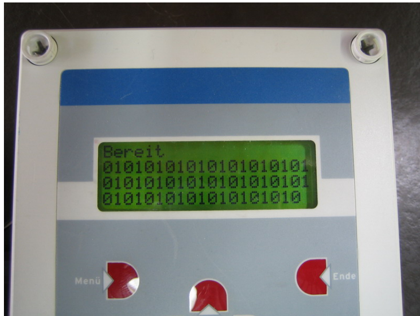
Bild: Messung von 60 Präambel Bit
