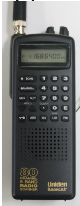
Bild: Funkscanner – eingestellt auf 168.64 MHz
